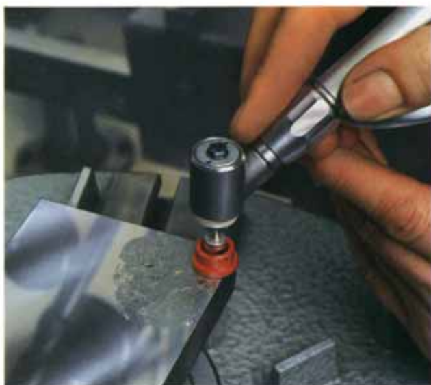
リング・フィニシ ハンドピースとつば付リングによる ラッピング加工
