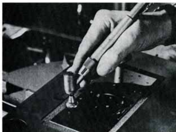
リング・フィニッシュ ハンドピース+布リングにより仕上中
