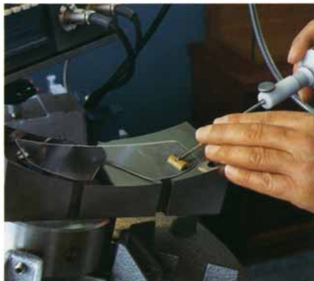
フレックス・ポリ マシンと特殊黄銅角体による ラッピング加工
