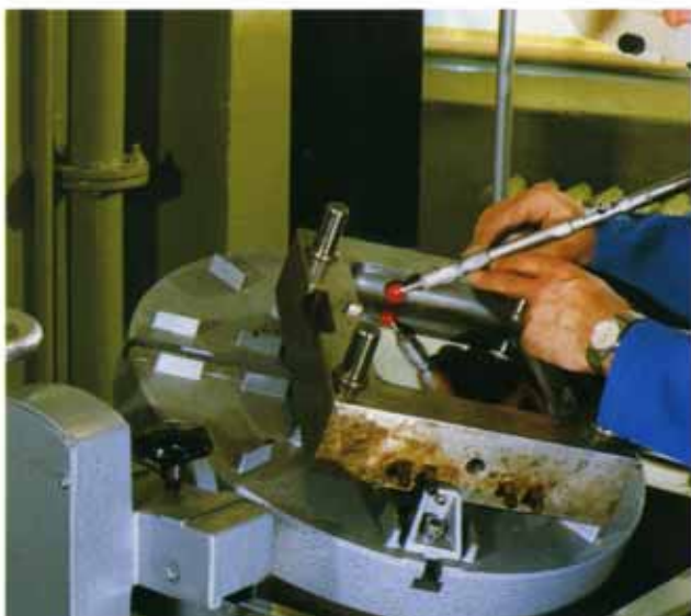
ポリ・ロータ ハンドピースとポリ・キャップによる R表面のポリシング加工
