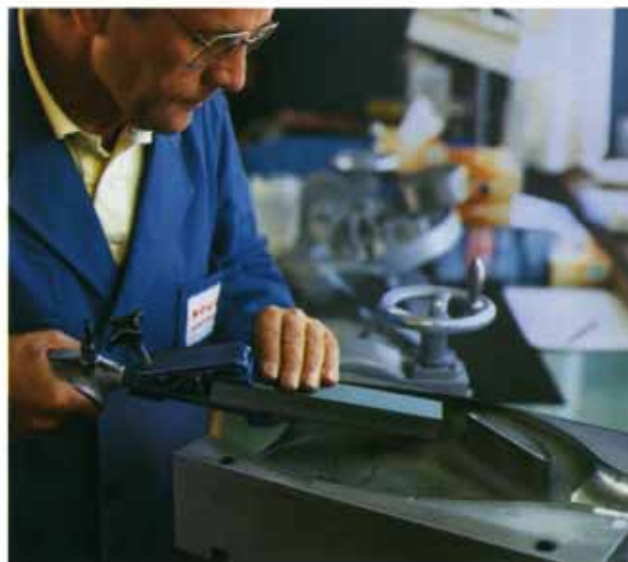
ストーン クランパーとSiCといしによる ボトル用ブロー金型の表面仕上加工
