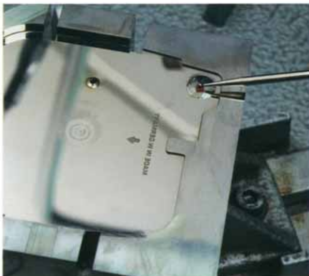
フレックス・ポリ マシンとポリ・ラップ角体による ポリ・ラッピング加工
