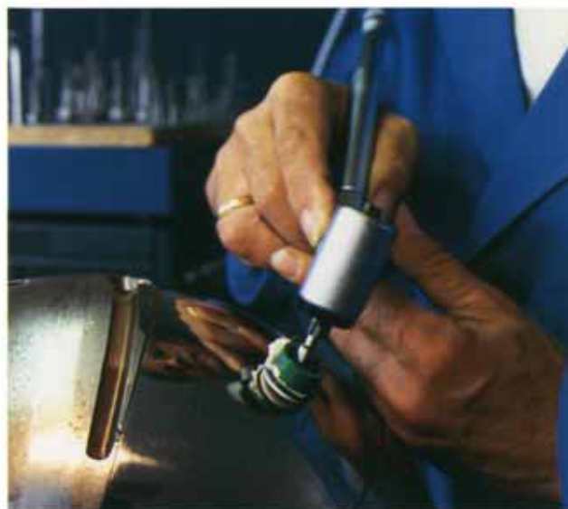
リング フィニシ ハンドピースと布ディスクリングによる ゴーグル用金型のポリシング加工
