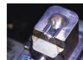
プラスチック金型の入れ子の溶接
